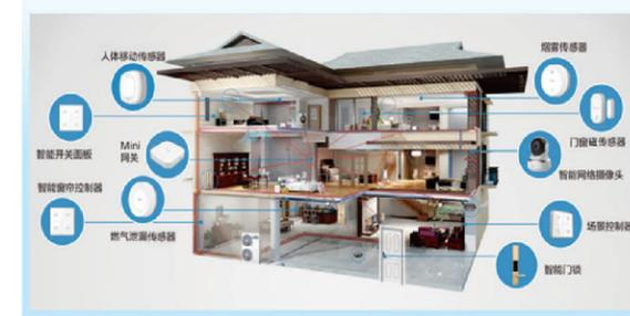
美的智慧家居安防套装包括人体移动传感器、门窗磁报警器、燃气泄漏探测器、烟雾传感器，实现对家庭、人身、财产的安全防护。门磁和人体移动传感器如探测到家中有人非法进入时，可自动发送警告信息给主人，在家中关键位置安装烟雾、燃气泄漏探测器，实时24小时不断监控，当发生火警或煤气泄露时，感应器会向用户手机或小区物业管理处发出警报消息。同时，配合自主研发的网关使用，安防套装可以与家电、家居等产品进行互联互通，实现家庭设备的智能化自运行，为用户提供便捷、舒适的未来智慧家居生活体验。
